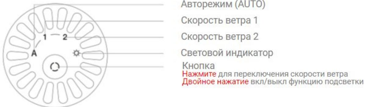
После включения питания устройство будет переключено в авторежим по умолчанию, система подачи воздуха автоматически установит скорость подачи ветра с первых секунд работы механизма в соответствии с окружающей температурой.
